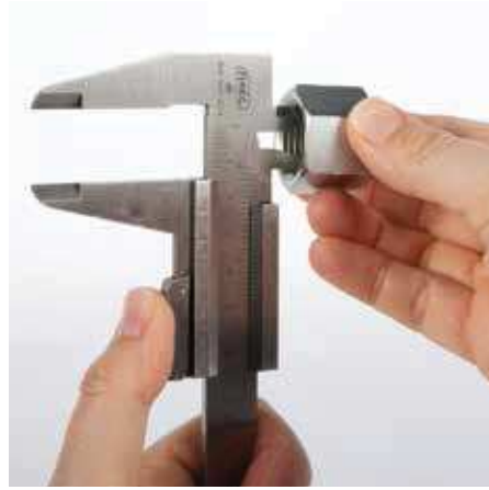
Misurare il diametro del filetto interno FEMMINA = F
