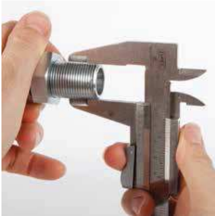
Misurare il diametro del filetto esterno MASCHIO = M
